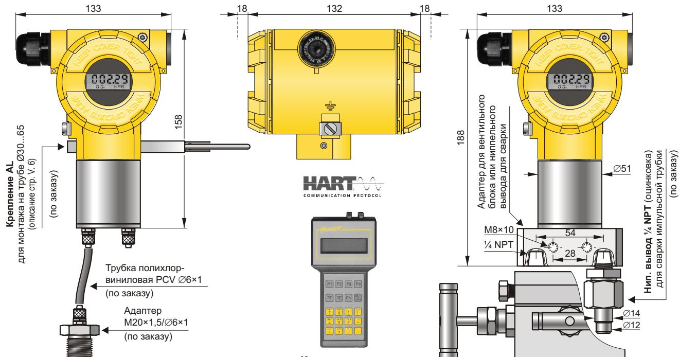
APR-2000G экономичное исполнение, присоединение **типа PCV**, штуцеры с зажимными гайками для трубок Ø6. Пример с корпусом **типа ALW**
